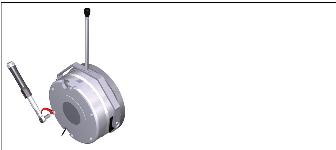
Abb. 9 Montage Magnetteil an das Lagerschild
