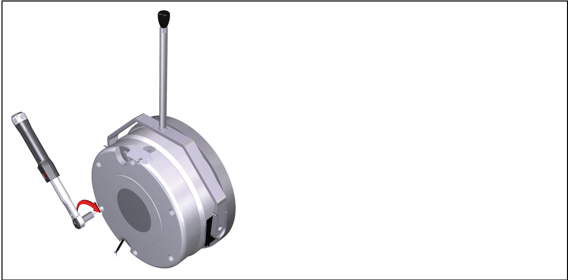
Abb. 13 Montage Magneteil an das Lagerschild bei Doppelrotorausführung
